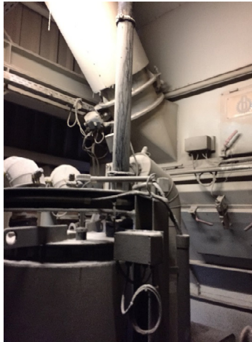
Entstaubung am Mischer
