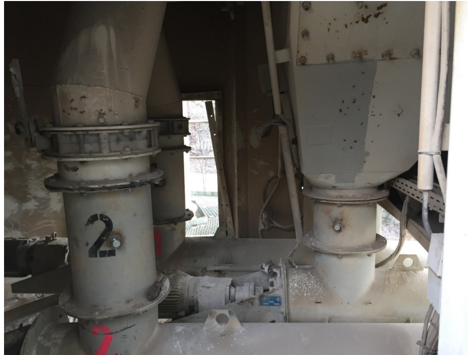
„Transport“ Füller über Schnecken zur Waage (ohne Zellenradschleuse)
