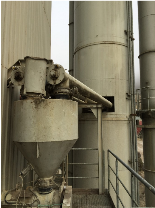
„großer“ Waagenbehälter für 3,0 t Mischer
