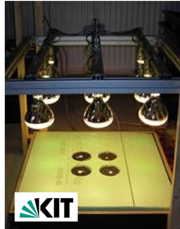
Bestrahlungsstand mit Sonnenlichtlampen
