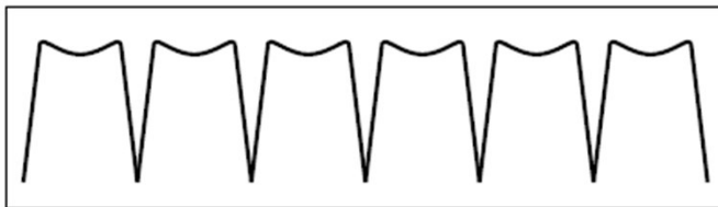
Abbildung 4: Systematische Darstellung einer konkaven Oberflächen- struktur (Plateau mit Vertiefungen)
